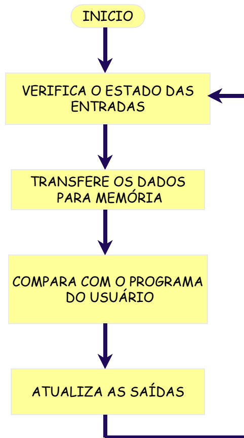
Figura 1.1 – Ciclo de Varredura de um CLP
